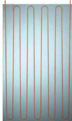
Méandre simple (EM) jusqu'à 3 capteurs dans la connexion en série, jusqu'à 5 avec un faible débit.
