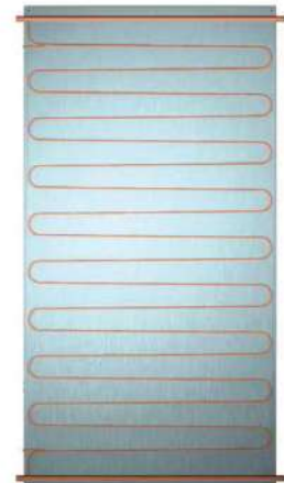
Capteur de méandres avec tube capteur (MS) jusqu'à 10 capteurs en parallèle à la connexion, jusqu'à 15 capteurs avec un faible débit.
